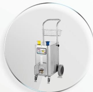
Générateur de vapeur monophasé avec un système de recharge automatique, injection de détergent et connexion directe au réseau d'eau. Carrosserie en acier inox imperméabilité IPX5. Dispositif digital avec manomètre, thermomètre, compte-heures et témoin d'indication de calcaire pour le nettoyage de la chaudière. Attention, cet appareil est vendu sans tuyau.
