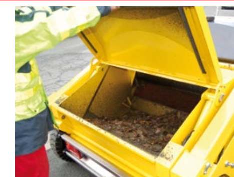
Trappe de contrôle du remplissage du bac
