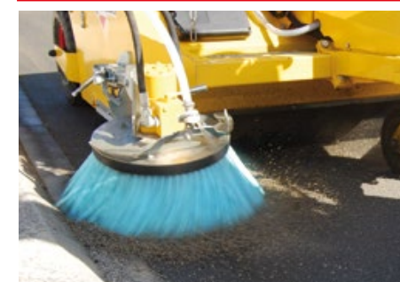
Option balai latéral Ø 700 mm en polyester ou acier rilsan
