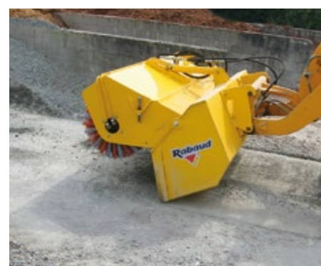
En marche avant : utilisation du godet avec balai relevé pour dégrossir ou charger .
