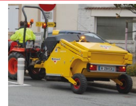
Relevage hydraulique de la balayeuse pour le transport (sur le modèle TRAINÉE)
