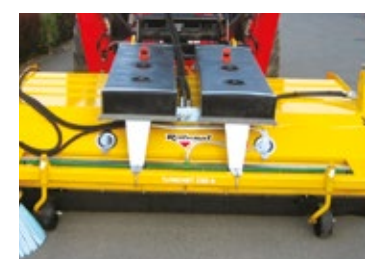
Arrosage par gravité ou pression avec deux cuves de 100 L
