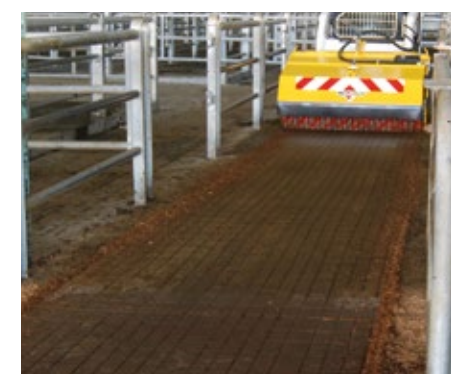
En marche arrière : balai baissé pour finition et balayage avec remplissage du godet.
