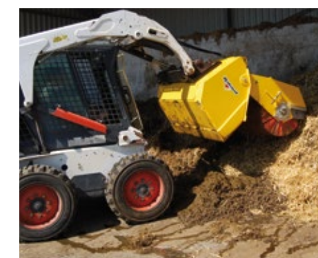
Vidange du bac par vérin hydraulique
