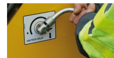
Réglage de la hauteur du balai selon l'usure
