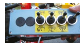
Commande électro-hydraulique depuis le poste de conduite (option)
