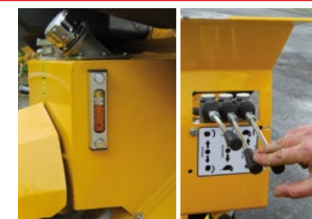
Option centrale hydraulique avec distributeurs
