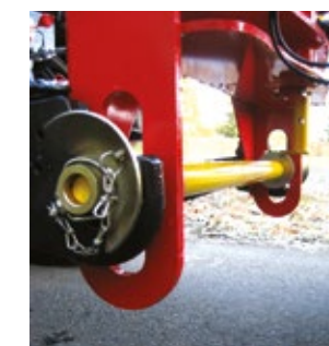
Attelage flottant pour suivre la conformité de la route
