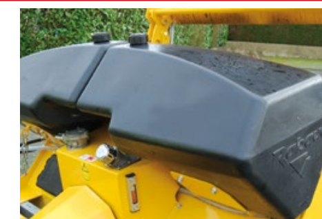
Option arrosage avec 2 cuves opaques de 150 L
