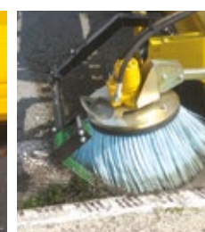
Griffes de nettoyage des caniveaux
