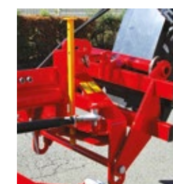
Interface mixte pour adaptation sur 2 ème porteur type télescopique
