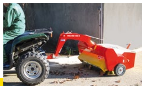
BALAYEUSE TRACTÉE 1000A avec entraînement du balai par les roues
