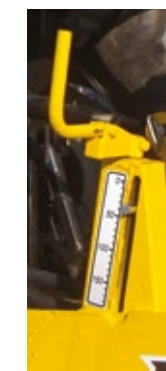
Manivelle pour : - faciliter le réglage de la hauteur du balai.
