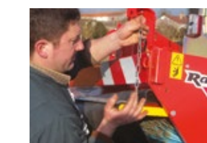
Réglage de la bavette anti-projections
