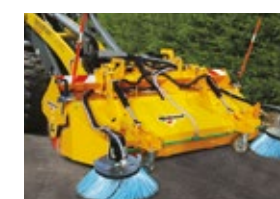
Balais latéraux + Kit de signalisation + Bac de ramassage
