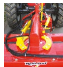
Rotation et déport hydrauliques
