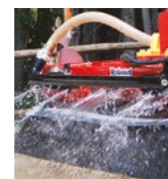
Arrosage gros débit avec rampe 4 jets et raccord type pompiers (sans cuve)
