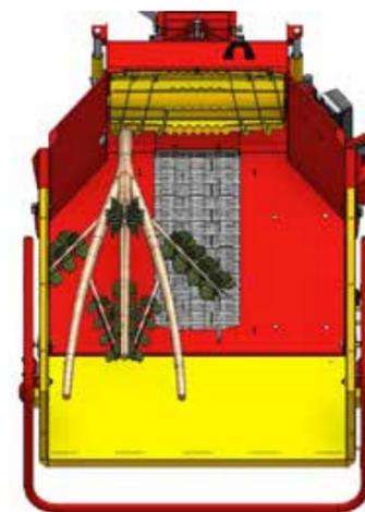
1 Exemple d'une branche posée sur le côté de la trémie.
