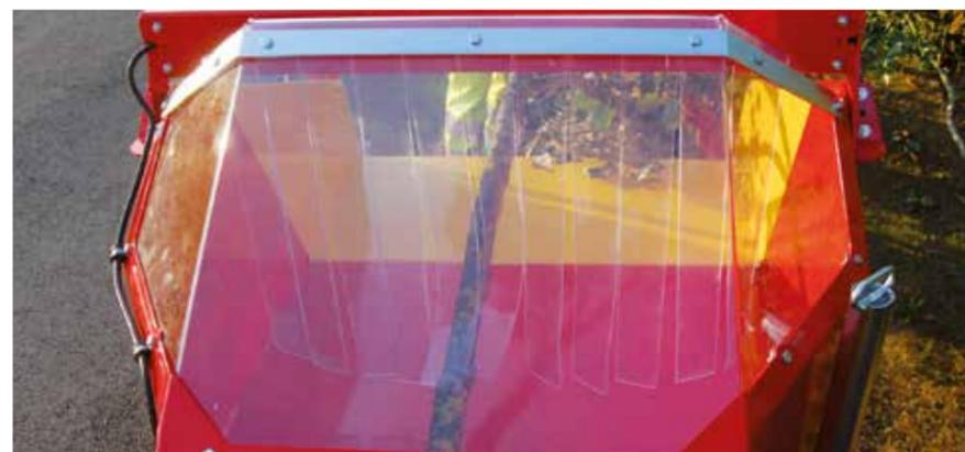
Grâce à cette conception (exceptés les XYLOCHIP 100), la visibilité est optimale pour l'opérateur. Le capot est en polycarbonate offre une résistance accrue.
