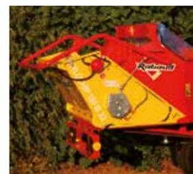
Trémie repliable pour plus de compacité au transport.
