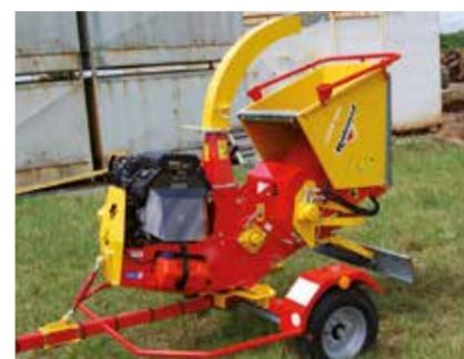
Trémie repliable pour le transport
