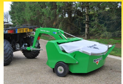
BALAYEUSE TRACTÉE 1000A avec entraînement du balai par les roues
